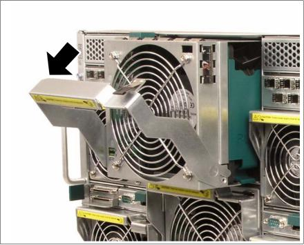
Figure 84: Removing the fan unit
